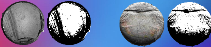
รูปพืชม้าแตกหักจากการล้าของเหล็กกล้าโรลลิม
